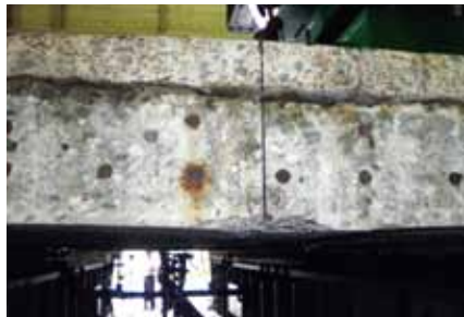
■ 輪荷重移動載荷試験機による輪荷重走行試験 ■
