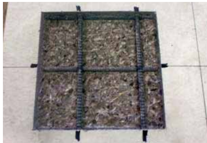
■ 補修材と既設床版の付着強度 ■
