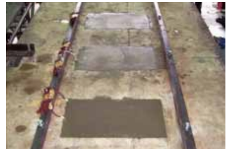
■ 輪荷重移動載荷試験機による輪荷重走行試験 ■
